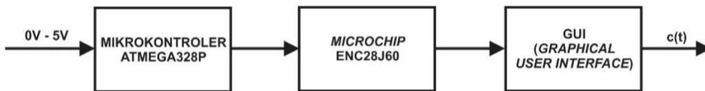
GAMBAR 5. Diagram Blok Kendali Sistem Pengukuran Kualitas Udara Dan Kebisingan
