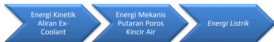
Gambar 3.1 Proses Konversi Energi PLTMH
